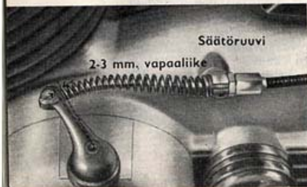
Vaihdevaijerin säätö Kytkinvaijerin säätö
